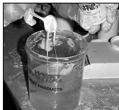
Tilsett ønsket fargetilsetting eller grafittpulver (kun til teak) sammen med epoxylimet.
